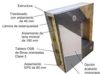
Muro exterior de 30 cm de grosor con SATE (Sistema de Aislamiento Térmico Exterior)
