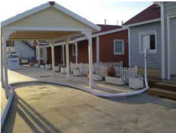
Montaje con tubo de 30 m. para medir su conductividad
